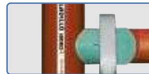
2- Inicie el calentamiento simultáneo del tubo y la montura de derivación utilizando las boquillas especialmente provistas.
