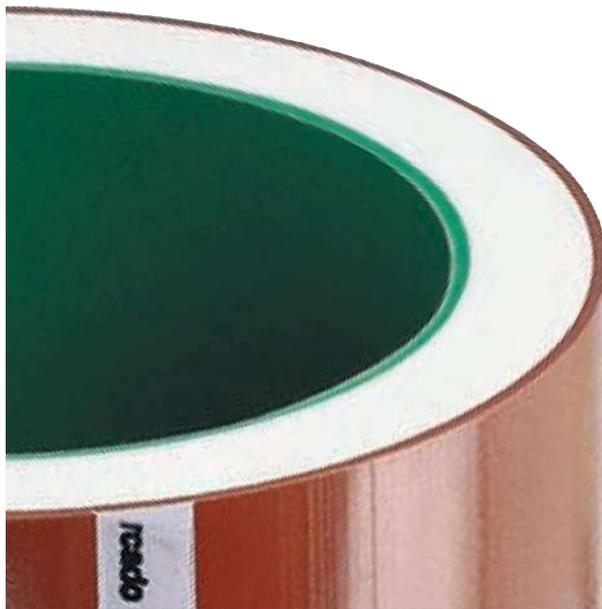
Las tuberías Saladillo H3 Aluminio son 100% impermeables al oxígeno. Esta característica evita que el oxígeno ingrese a través de las paredes de la tubería y se difunda en el agua iniciando la corrosión de todos los elementos metálicos comprometidos en los circuitos cerrados de calefacción.
